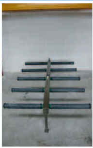
Gruppo di aerazione a diffusori tubolari. Tube diffusers system.
